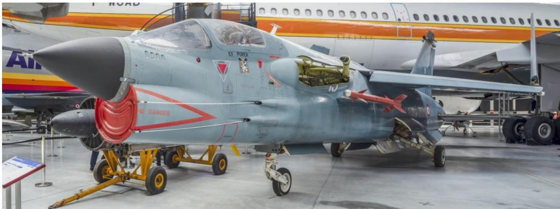
L'appareil présente plusieurs caractéristiques peu habituelles pour un avion de chasse ; il dispose d'une aile haute, et à incidence variable afin d'abaisser la vitesse d'approche tout en offrant au pilote une bonne visibilité vers l'avant et vers le bas, une nécessité pour l'appontage.
